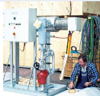
einem Gerät, das Schlachtmesser zu 100 Prozent bakteriologisch rein und äußerst ressourcenschonend säubert. Denn das zeichnet SteriCut aus: Über ein neuartiges Verfahren können beim Reinigen bis zu 90 Prozent an Wasser, Energie und Entsorgungskosten eingespart werden. Das Gerät hat eine ein-
