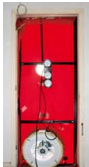
Mit dem Blower-Door-Test wird die Luftdichtigkeit von Gebäuden gemessen.
