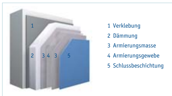
Schematischer Aufbau eines Wärmedämm-Verbundsystems
